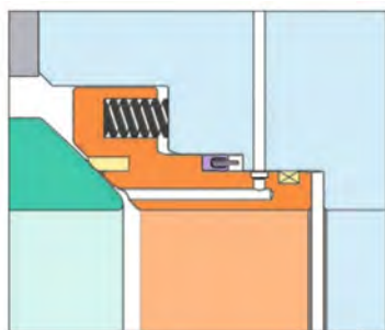
Конструкция манжетного уплотнения
