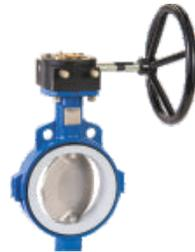
Las válvulas de hasta 24" se pueden montar directamente con operadores de engranajes para operación manual. Los operadores de engranajes, también se pueden suministrar con operadores de ruedas de cadena para abrir o cerrar válvulas ubicadas en tuberías en elevaciones altas.
